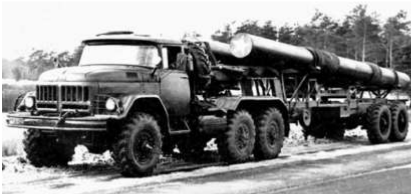
Рисунок 1 – Автопоезд ЗИЛ-137 с гидроприводом колес полуприцепа и имитацией ракетного оружия. 1970 год
