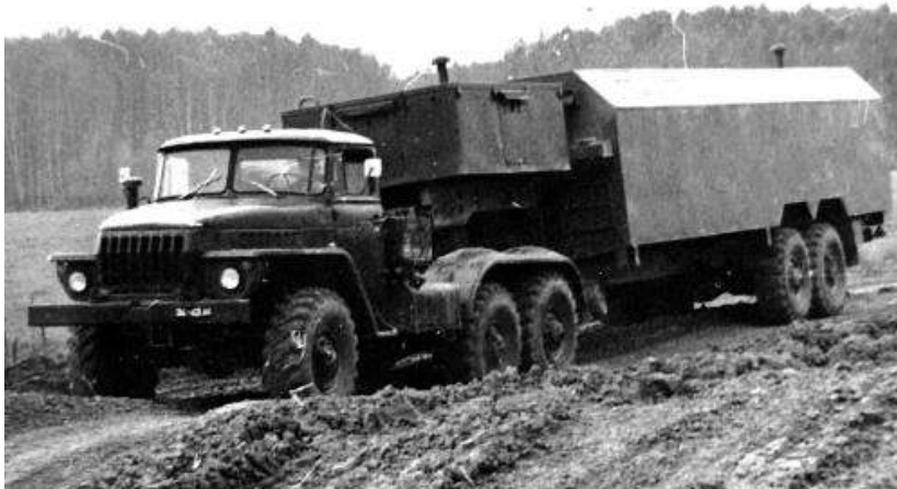
Рисунок 3 – Седельный тягач «Урал-44201» и полуприцеп «Урал-862А» с кузовом-фургоном КМ-862. 1980 год
