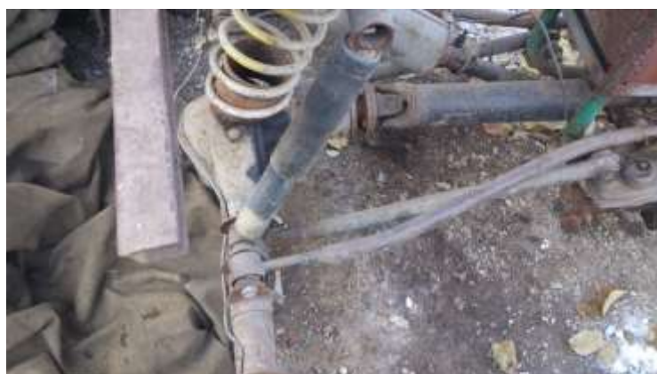
Рис. 8. Задний ведущий мост багги
