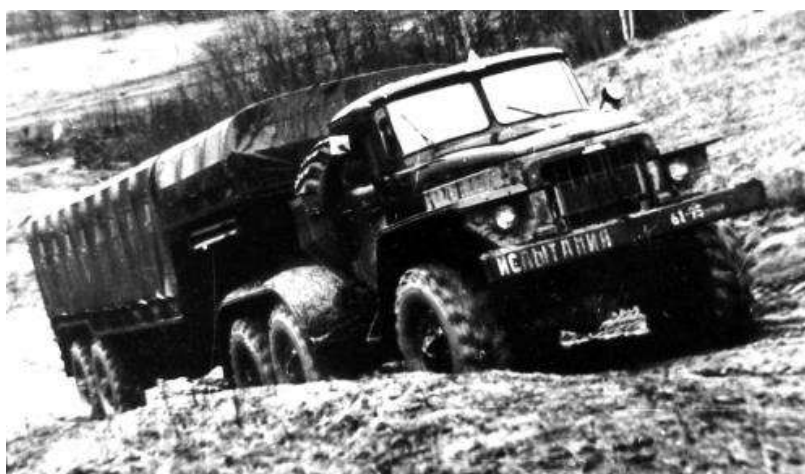
Рисунок 2 – Специальный тягач «Урал-380» с механическим приводом полуприцепа «Урал-862». 1965 год
