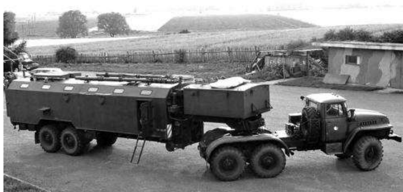
Рисунок 4 – Пункт служебной радиосвязи Р-362М «Орех» в кузове К-862 на автопоезде «Урал-44201-862»
