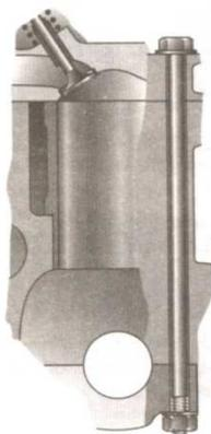
**Рис.6. Крепление головки блока анкерными болтами**
