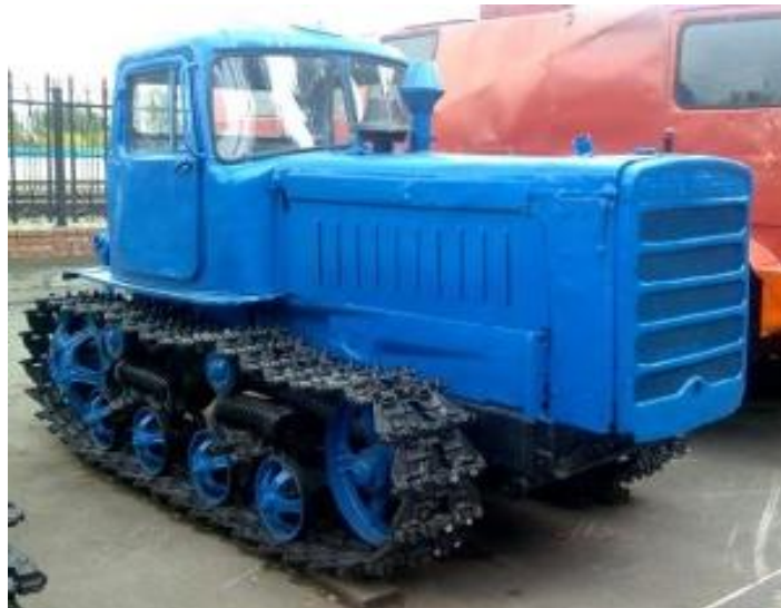
Рис. 3.56. Гусеничный трактор общего назначения ДТ-75
