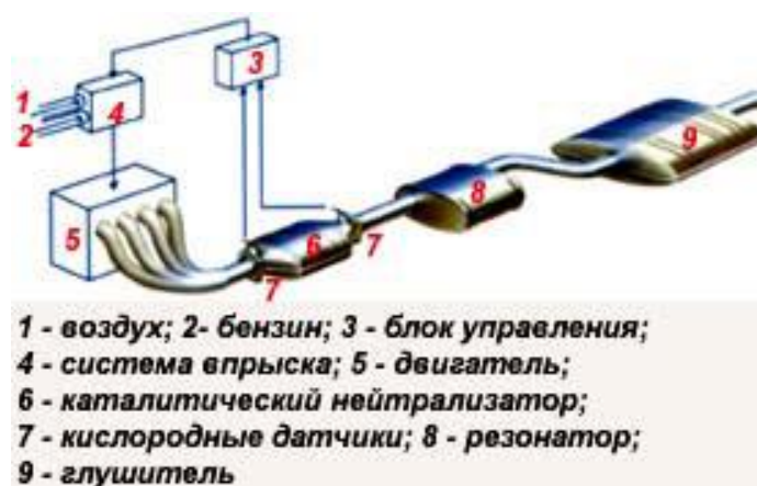
Рис. 3.135. Работа каталитического нейтрализатора двигателя
