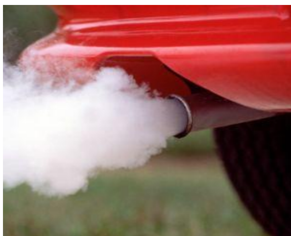
Рис. 3.65. Выхлопные газы – продукты окисления и неполного сгорания углеводородного топлива
