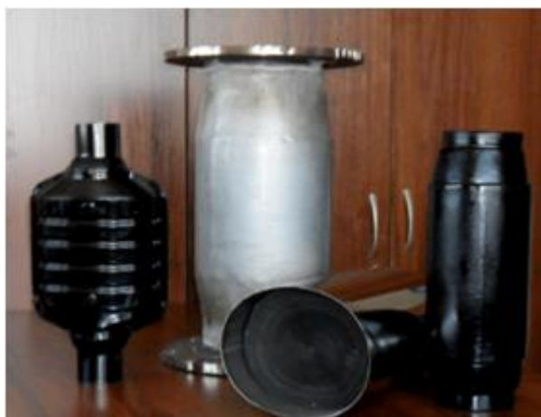
Рис. 3.15. Сменные фильтры каталитического нейтрализатора на выпуске
