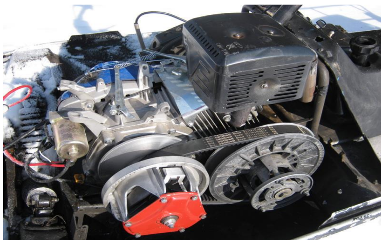
Рис. 3.85. Четырехтактный одноцилиндровый бензиновый двигатель для снегохода Буран 410 см с электростартером
