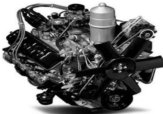
Рис. 3.61. Карбюраторный двигатель, устанавливаемый на квадроциклах до 80-х годов
