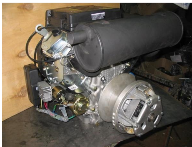
Рис. 3.86. Четырехтактный двухцилиндровый бензиновый двигатель для снегохода Буран 680 см 3
