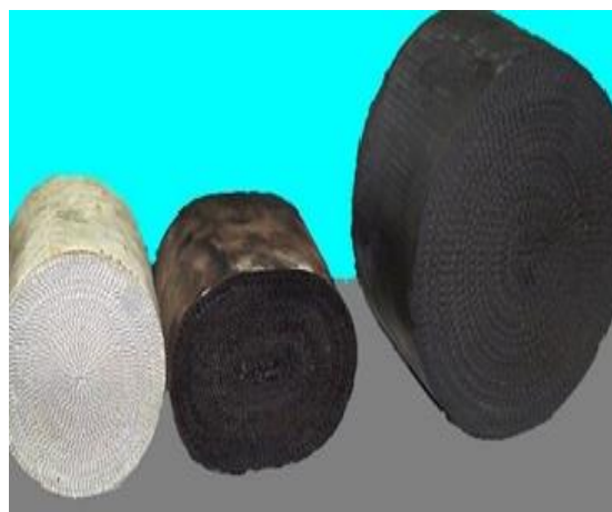
Рис. 3.15. Сменные фильтры каталитического нейтрализатора на выпуске
