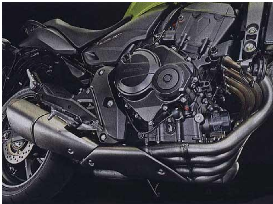
Рис. 3.103. Новейшая тенденция – короткий глушитель, размещенный у силового агрегата (Honda CB1000R)
