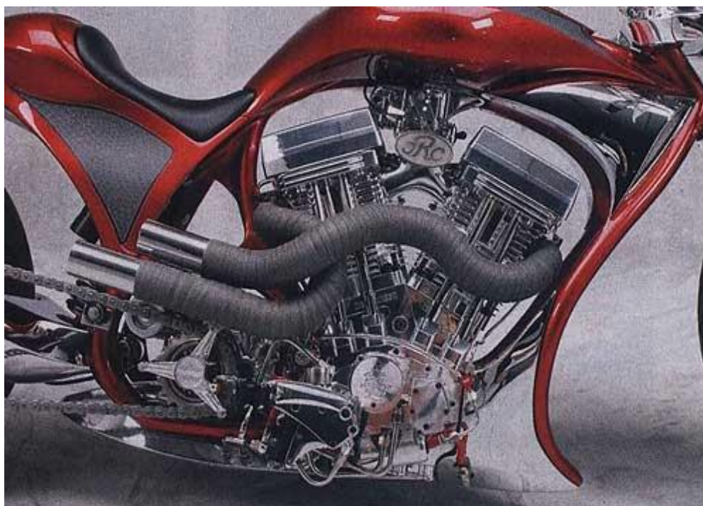
Рис. 3.104. Конструкция выхлопа – выпускные трубы, обмотанные термозащитной лентой
